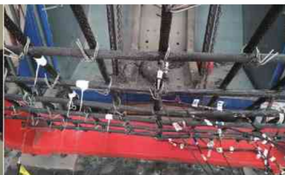
钢筋外覆碳纤维增强复合材料四边支撑索网结构冲击试验
