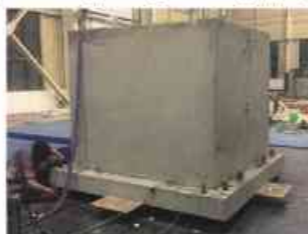
减震贮液结构振动台试验
