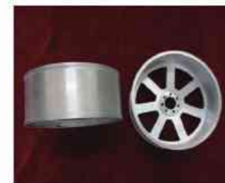
AZ91D 镁合金自孕育流变压铸薄壁件
