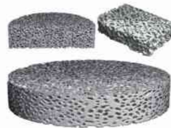
图1. 多孔 Ti 的断层扫描及三维重构
