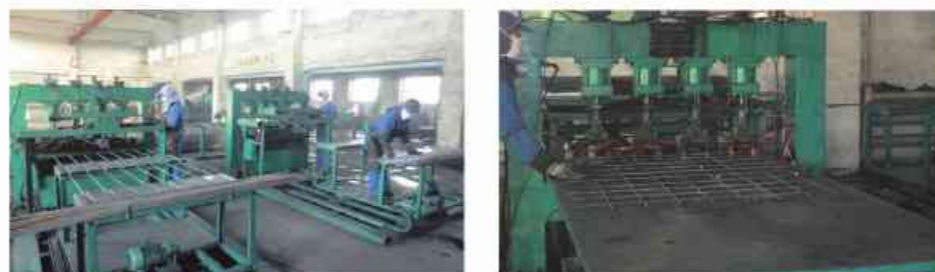
矿山用钢筋网架自动焊接设备
