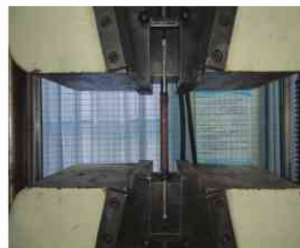
钢筋外覆碳纤维增强复合材料拉伸试验
