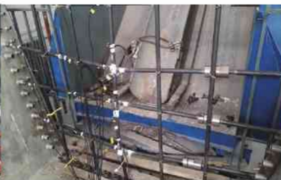
柔性钢筋防护网试验
