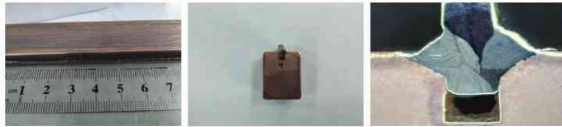
铜 - 钢激光角焊缝宏观图
