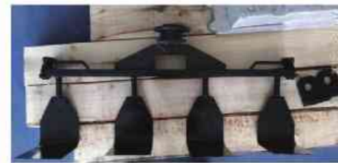
图 2 铝锭打渣机器人配备打渣铲
