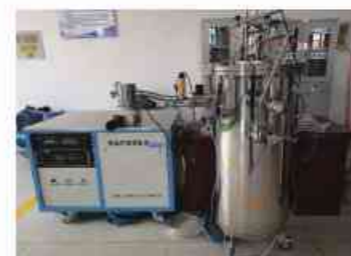
VDMLI 绝热的低温试验贮箱
