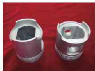
A390 过共晶铝硅合金受控扩散凝固挤压成形汽车活塞件
