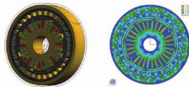
1.0kW 磁齿轮复合发电机
