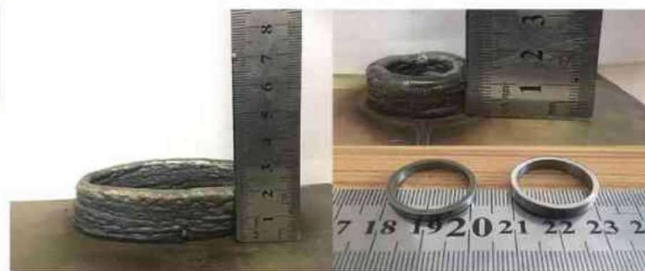
图2 曲面零件堆垛成形件
