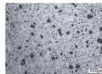
受控扩散凝固挤压成形活塞件金相组织
