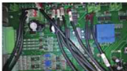
单通道电液比例控制阀高速开关阀控制器控制器 PCB 版
