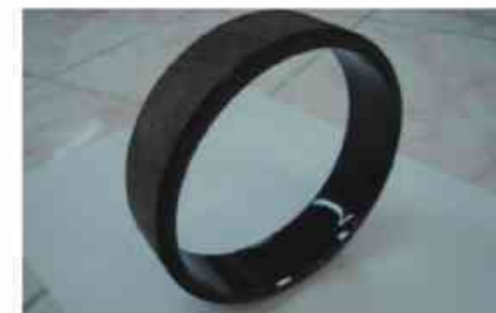
内壁制备了耐高温耐磨蚀搪釉涂层的圆环管件
