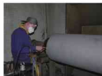
在顶吹炉喷枪外壁制备的耐高温金属陶瓷涂层
