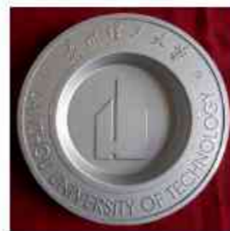
AZ91D 镁合金自孕育流变压铸薄壁件
