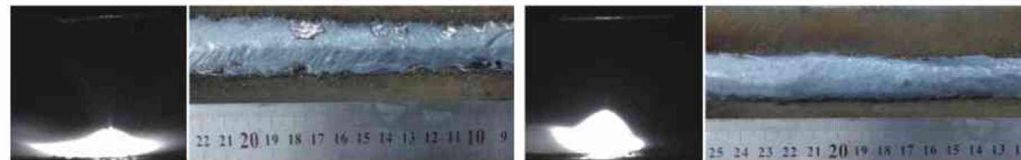
图 2 交变磁控高效 GMAW 焊接工艺熔滴过渡行为
